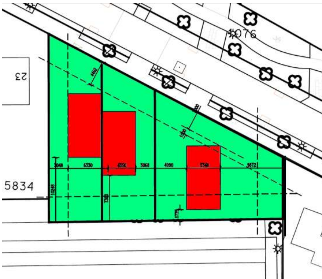
Uitgangsmodel 0 uitgewerkt tot verkavelingstekening. De tweekapper kan zowel getrapt (zoals weergegeven) worden uitgevoerd, dan wel met gelijkliggende voorgevels
