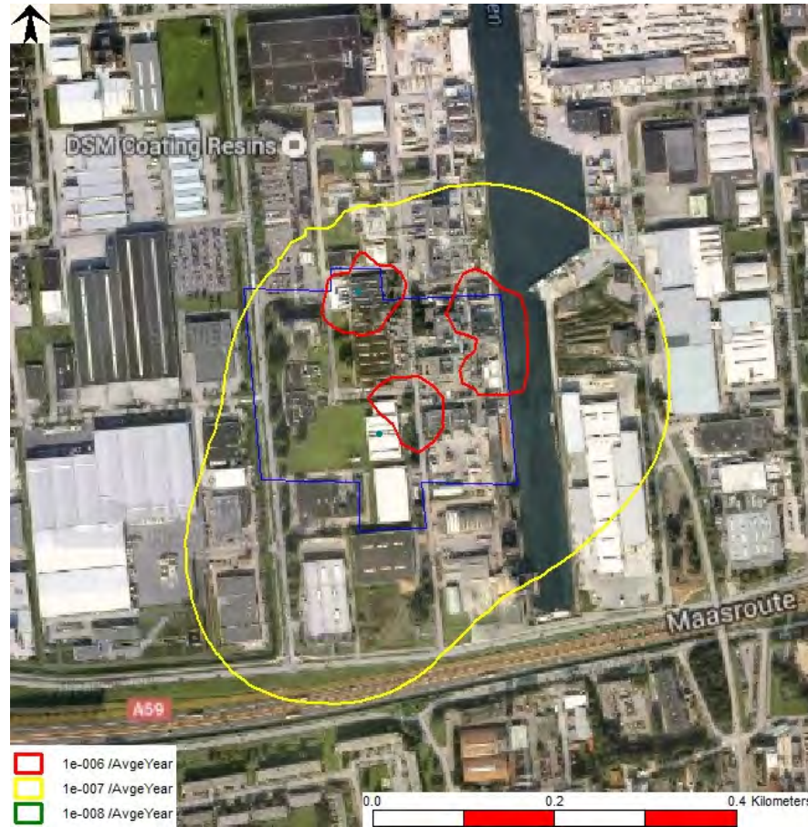
Figuur 3: Plaatsgebonden risico Stahl te Waalwijk (zoom)
